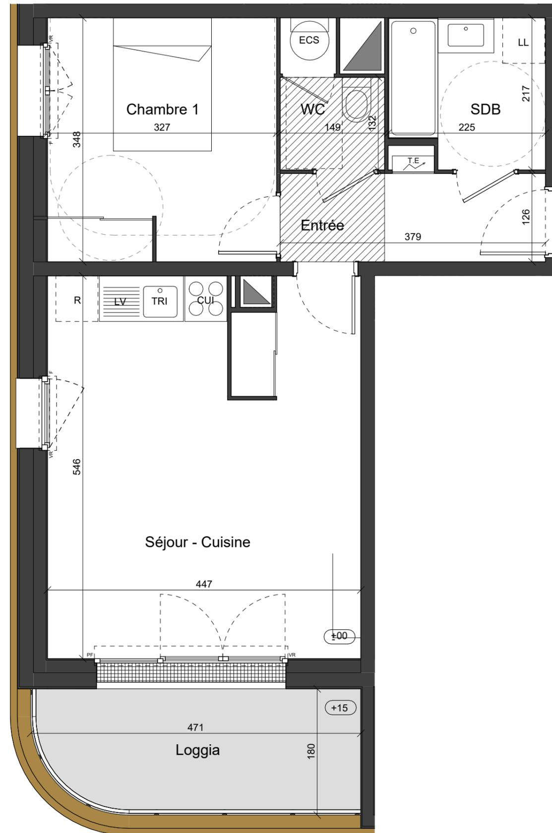
LÉGENDE : P.F. : Porte Fenêtre / F. : Fenêtre / F.A.B. : Fenêtre Allège Basse / V.R. : Volet Roulant / T.E. : Tableau Électrique / PL. : Placard / CUI. : Cuisson / R. : Réfrigérateur / L.L. : Lave Linge / L.V. : Lave Vaisselle / Soffite, faux plafond Espace BUREAU Niveau +15
